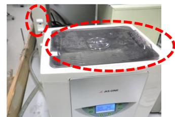
振動による内容水の飛散防止策
