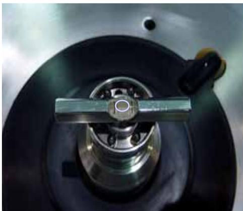
回転軸上に水準器を置き、水準器の気泡が中心にあること。
