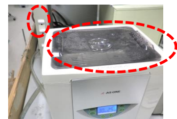
振動による内容水の飛散防止
